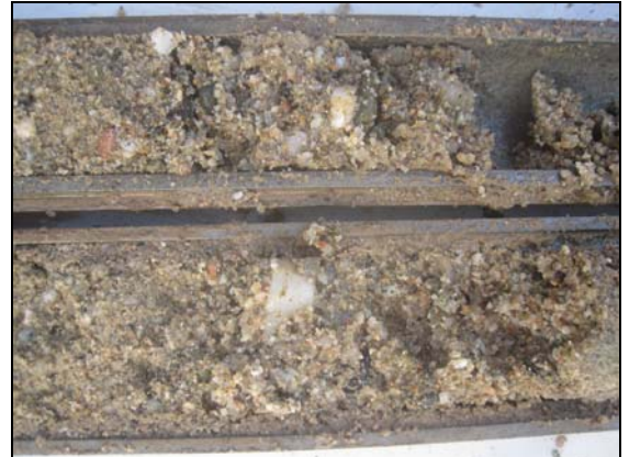
Foto 14: Sondeig S-2. SPT a 10,5 metres.
